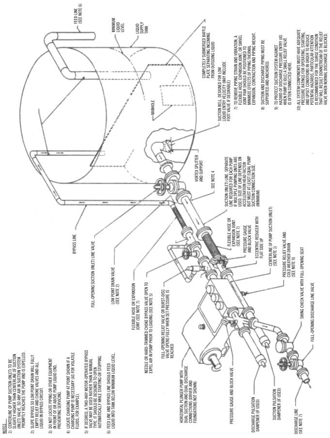
SUGGESTED PIPING SYSTEM FOR PLUNGER PUMPS
